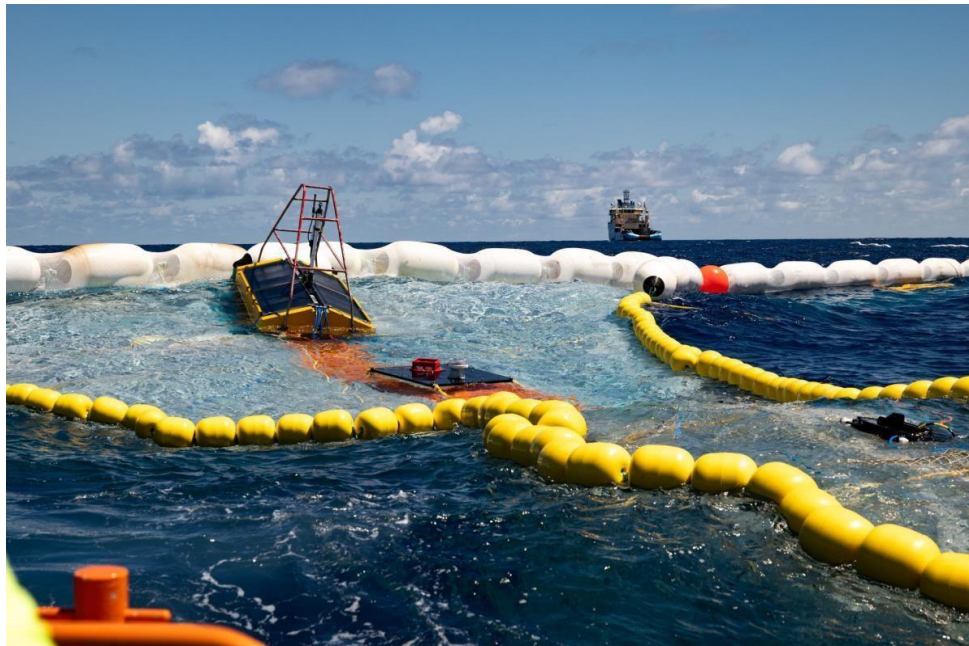
Gambar 3. Menampilkan sistem pengoperasian boom otomatis terapung milik organisasi The Ocean Cleanup di tengah lautan.
