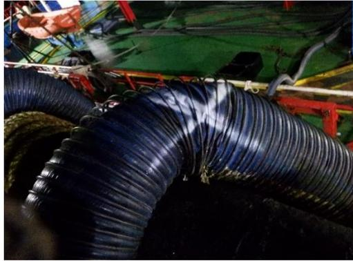
Gambar 2. *Spiral Guard* yang rusak pada hosse 8 inch.
