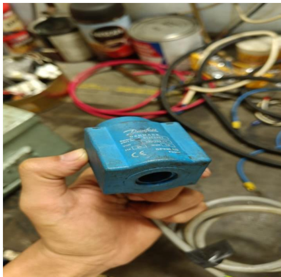
Gambar 3. Selenoid Valve yang rusak
